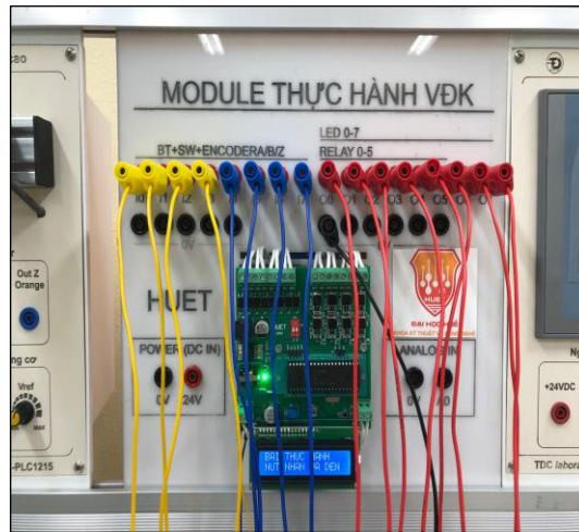
Hình 17. Mô đun thiết bị của đề tài trong bộ thực hành PLC có sẵn
