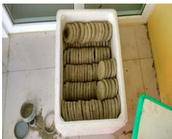
a. Đất sét trộn với bã cà phê trước khi nung
